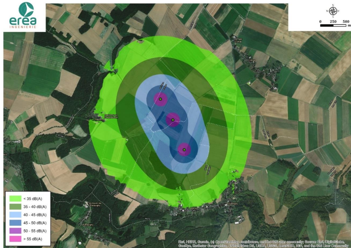
Carte 49 : Isophones pour la configuration V117-4, 2MW pour un vent de vitesse standardisée de 10 m/s et provenant du secteur (315°-135°)
