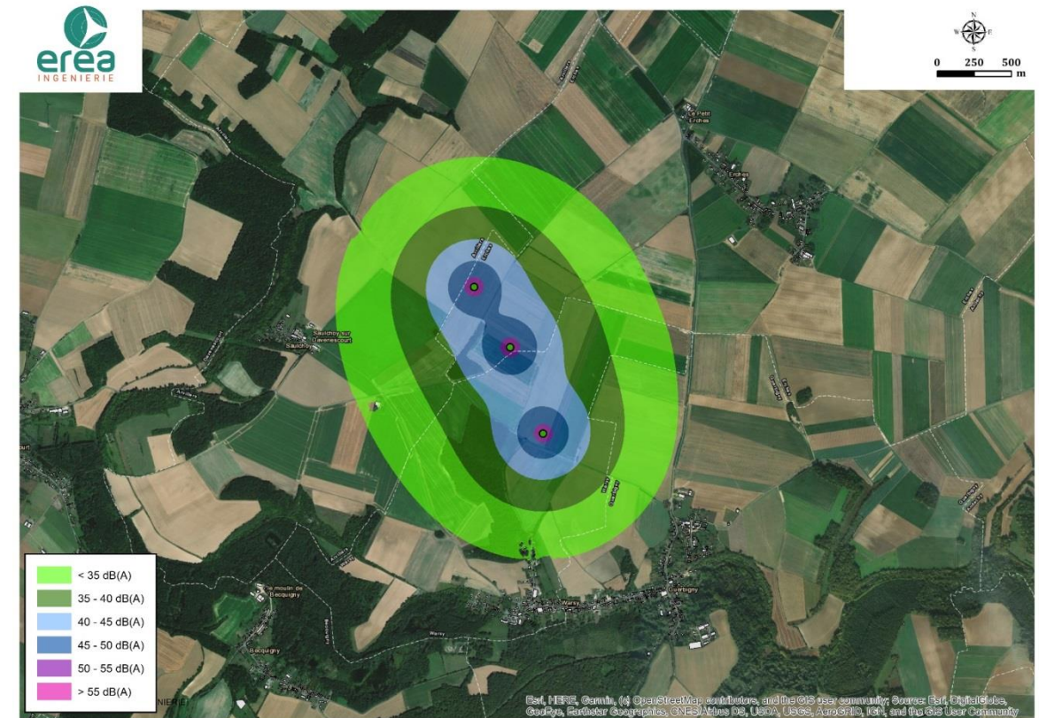
Carte 51 : Isophones pour la configuration N117-3, 6MW pour un vent de vitesse standardisée de 10 m/s et provenant du secteur (315°-135°)
